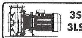
monoblokové prevedenie so štandardným motorom a pružnou spojkou
