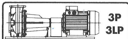
prevedenie na podstave so štandardným motorom a pružnou spojkou
